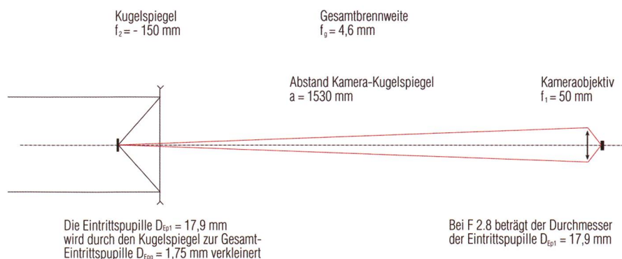
Abbildung 3: Schematische Darstellung des Strahlenganges in einer zweistufigen Abbildung. (Grafik nach: Peter C. Slansky)
