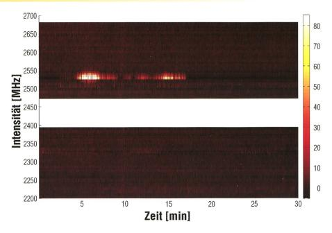
Abbildung 4: Nachtspektrum gewonnen mit dem CALLISTO Spektrometer währenddem ein Satellit das Antennendiagramm passiert. Die Interferenzmuster bei ca. 2530 MHz erlauben die Bestimmung der Satelliten-Winkelgeschwindigkeit.
