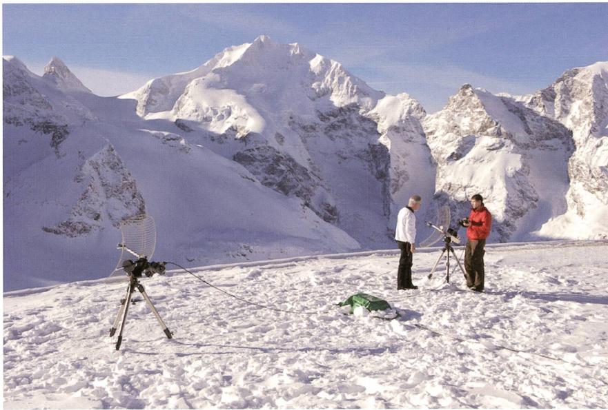
Abbildung 1: Zwei einfache, kostengünstige parabolische Gitterantennen wie sie für WiFi verwendet werden montiert auf zwei Advanced GoTo Celestron-Montierungen. Die Antennen sind in Ost-West-Richtung aufgestellt auf dem Flachdach des Hotels Diavolezza. Im Zentrum unter der grünen Plane befindet sich der rauscharme Frequenzumsetzer von S-Band nach VHF. Das nun niederfrequente VHF-Signal wird dann ins Observatorium geleitet und dem Spektrometer zugeführt. Im Hintergrund Crast Agüzza und Piz Bernina. (Foto: Heidi Hostettler, ETH Zürich)
