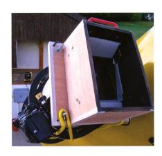
Das Objektivprisma aus Flintglas ist am Meade SNB Teleskop mit Gummiseilen befestigt und in Nord-Süd-Richtung ausgerichtet. (Foto: Sascha Gilli)
