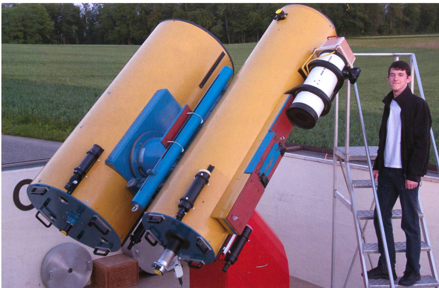
Zum Spektrographieren verwendete ich das Meade SNB Teleskop der Schul- und Volkssternwarte Bülach, welches vom 50cm-Newton/Cassegrain-Teleskop getragen wird. Auf der gleichen Montierung ist auch der 85er-Cassegrain-Reflektor (hinten links). (Foto: Jürg Alean)
