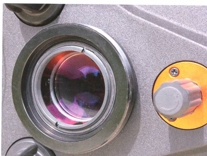
Abb. 4: Die HD-Linse sitzt sehr nahe beim Anschlussgewinde, wie im Bild links zu sehen ist. Die rechte Aufnahme zeigt einen Blick ins Blendenrohr mit dem Sekundärspiegel. (Bild: Jan de Lignie)
