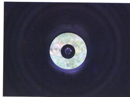
Abb. 4: Die HD-Linse sitzt sehr nahe beim Anschlussgewinde, wie im Bild links zu sehen ist. Die rechte Aufnahme zeigt einen Blick ins Blendenrohr mit dem Sekundärspiegel. (Bild: Jan de Lignie)
