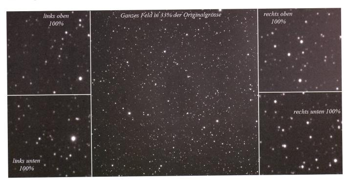
Abb. 8: Die gleichmässige Abbildung mit einem 15mm x 15mm Sensor des Celestron Edge HD 9.25" (Bild: Jan de Lignie)
