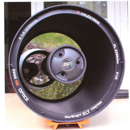
Abb. 2: Frontansicht mit Fastar-Option. (Bild: Jan de Lignie)
