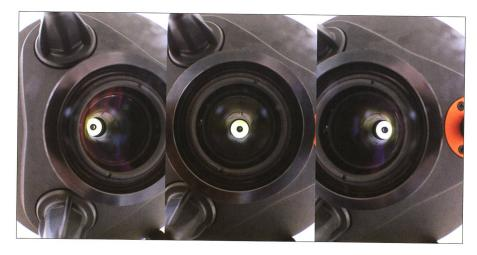
Abb. 5: Die Vignettierung ist kein Thema. Links und rechts war die Kamera parallel zur Rohrinnenwand; hier verträgt es auch noch einen Reducer! (Bilder: Jan de Lignie)
