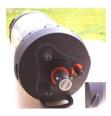
Abb. 3: Rückseite mit Fokussierknopf, Mirrorlocks und vergrössertem Lüftungsschlitz. (Bild: Jan de Lignie)
