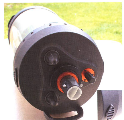
Abb. 3: Rückseite mit Fokussierknopf, Mirrorlocks und vergrössertem Lüftungsschlitz. (Bild: Jan de Lignie)
