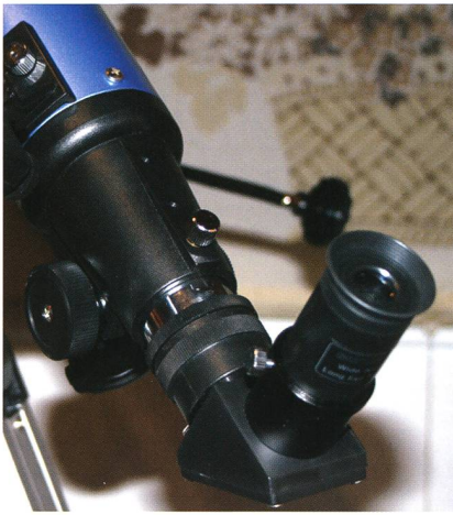
Fig. 2: Hier sehen wir den Okularauszug mit Umlenkprisma.
