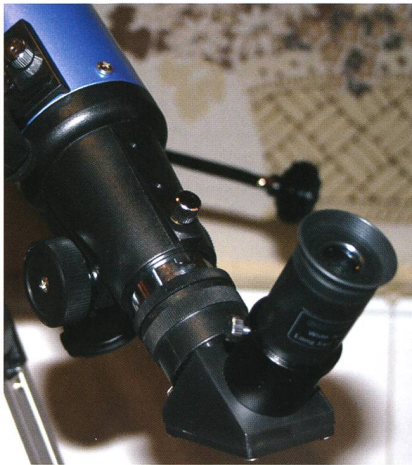
Fig. 2: Hier sehen wir den Okularauszug mit Umlenkprisma.
