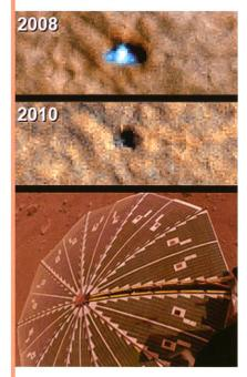
Während mehr als 200 Flüge von Orbiter Mars-Odyssey über der Landungsstelle horchte die Sonde nach Funksignalen von Phönix. Aber jeder Horchversuch endete ergebnislos. Nach den jüngsten vom Orbiter geschossenen Aufnahmen fielen die Solarpanels von Phönix durch die durch die Vereisung durch Kohlendioxid verursachte Verformung aus. «Wir haben keine Hoffnungen mehr», sagte der Vertreter der NASA, PETER SMITH. (aba)
