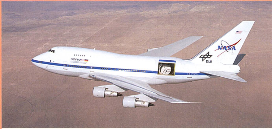
Bild: Das Stratosphären-Observatorium Sofia während seines ersten Testflugs mit vollständig geöffneter Teleskoptür am 18. Dezember 2009 über der kalifornischen Mojave-Wüste. Foto: NASA/C. Thomas.
