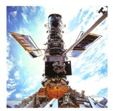
Abb. 4: Astronauten ersetzten Gyroskope während der dritten Service-Mission. Das Hubble wurde mit dem Greifarm des Spaceshuttles eingefangen und auf dem Spaceshuttle befestigt. (Bild: NASA)
