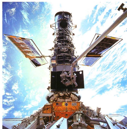
Abb. 4: Astronauten ersetzen Gyroskope während der dritten Service-Mission. Das Hubble wurde mit dem Greifarm des Spaceshuttles eingefangen und auf dem Spaceshuttle befestigt. (Bild: NASA)
