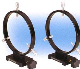
Wir bieten Leitrohrschellen in den Durchmessern 90mm, 108mm, 125mm und 160mm an, so dass Sie ein breites Spektrum an Optiken auf dem Meade-Gerät montieren können. Auf den Spitzen der Einstellschrauben verhindern weiße Kunststoffeinsätze das Verkratzen der Zusatzoptiken.
