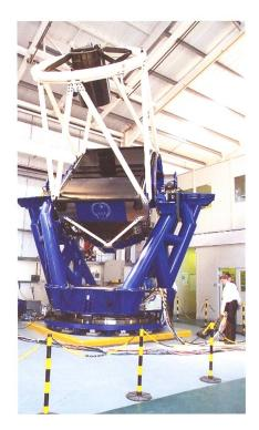
Das 25 Tonnen schwere Faulkes"-Teleskop ist mit seinen 20 Metern Brennweite eine gewaltige Sehmaschine. (Werkfoto FTN)
