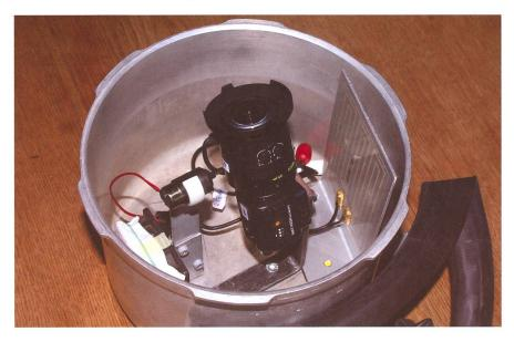
L'apparecchiatura alloggiata nella pentola; la videocamera, la termoresistenza (sulla destra), la ventola (in basso a sinistra), il motorino (a sinistra della videocamera). Mancano i sensori di umidità, di temperatura, la copertura in alluminio, i granuli disseccanti e i cablaggi.
