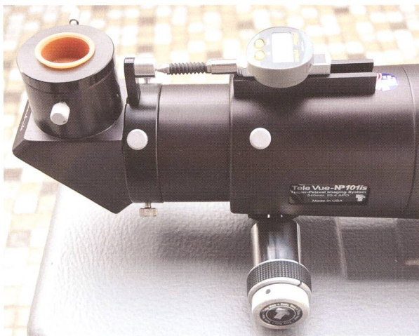
Gros plan sur le comparateur Sylvac pour la mesure de l'amplitude du porte oculaire et sur le mécanisme de mise au point démultipliée Focusmate. (Photo: Robert Rivoir)
