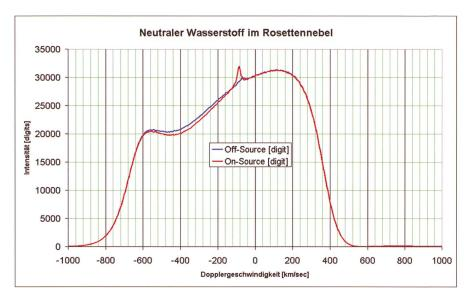
Abbildung 4: Messkurve von neutralem Wasserstoff im Rosettennebel bei 21cm Wellenlänge. Die rote Kurve zeigt die Strahlungsintensität bei Ausrichtung des Teleskops auf den Rosettennebel. Die blaue Kurve ist die Intensität während das Teleskop auf die Referenzposition bei  $\alpha=08$  h 30 m 42.00,  $\delta=05^{\circ}$  01' 00.0'' ausgerichtet ist. Ausgewertet als Linienprofil wird dann die Differenz der beiden Signale, so dass instrumentelle Artefakte herausfallen.
