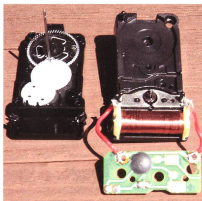
Modifikation des Uhrwerkes. Der metallene Stator befindet sich in der rechten Hälfte bei der kupferfarbenen Spule. (Foto: Thomas Knoblauch)
