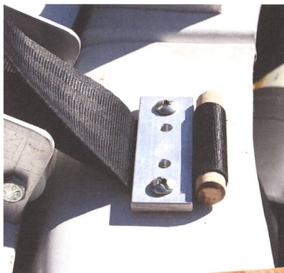
Abbildung 5: Reibungsbremse gegen den Restdurchschlupf der Gurte.
