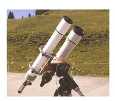
Abb. 6: Pentax 105/670 SDP, fotovisueller Astrograph. (Foto: Manuel Jung)
