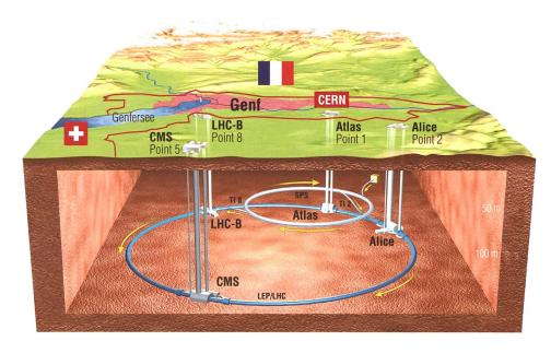
Schematische Darstellung des Teilchenbeschleunigers nördlich der Stadt Genf. Der LHC ist nicht der erste Teilchenbeschleuniger am CERN. Sein Vorgänger war der LEP (Large Electron-Positron Collider), der von 1989 bis 2000 in Betrieb war.
