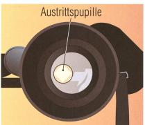
Situation ist unschön, da die Öffnung der Optik nicht ausgenützt wird. Ist die Austrittspupille des Instrumentes kleiner als jene des Auges ist die Situation nicht dramatisch, da lediglich nicht das Optimum herausgeholt wird.
