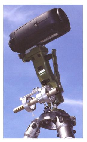
La rotule Manfrotto 222 dispose d'une petite queue d'aronde permettant de fixer un accessoire. Ici, un support artisanal permet de monter un laser vert en parallèle avec le SkyScout. Il est ainsi possible de guider grossièrement d'autres instruments dans la direction pointée par le SkyScout. Il ne faut toutefois pas s'attendre à des miracles de précision, mais le montage apporte une aide précieuse au handicapé de l'astérisme que je suis. (photo: Robert Rivoir)
