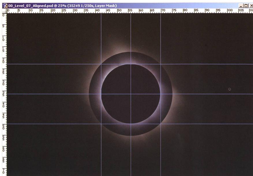
Pro Ebene muss eine Maske hinzugefügt werden. Deren Rand wird anschliessend mit Hilfe eines Gauss-Filters so stark verschmiert, bis ein optimaler Übergang zwischen den Bild-Ebenen erreicht wird.
