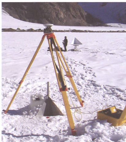
Professioneller Empfänger für die zentimetergenaue Ortsbestimmung mit Hilfe von Satellitennavigation (DGPS). (Foto Arnold Barmettler)
