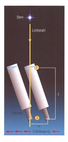
Figur 2: In der Zeit, die das Licht zum Durchlaufen des Fernrohrs braucht, hat sich die Erde etwas weiter bewegt. Das muss durch eine Neigung des Fernrohrs kompensiert werden. (Grafik: Thomas Baer)
