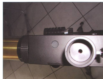
Fig. 2 (à gauche): Le préfiltre. Fig. 3: Bague hélicoïdale, le filtre bloquant et le système de visée du Soleil. (Photos: Gégory Giuliani)
