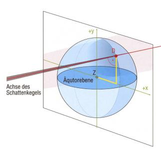
Figur 3: Die Fundamentalebene (gelb) steht senkrecht zur Achse der Schattenkegel (rot), sie geht durch das Erdzentrum Z. D ist der Durchstosspunkt der Achse mit den Koordinaten X und Y. (Grafik nach E. Laager: Thomas Baer)
