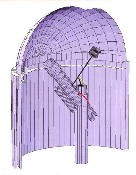
Figur 5: Simulation einer Teleskop-Säulen-Kollision weit weg vom Zenit. Das Teleskop ist auf den Pol ausgerichtet und Kollisionen finden in einem grossen Bereich des Stundenwinkels statt. Die Stundenachse ist grün eingezeichnet, Teile der Wände und die halbe Kuppel sind im Hintergrund sichtbar.
