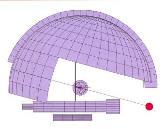
Figur 3: Die Abbildung zeigt einen Teil der Kuppel und das Teleskop von oben. Die schwarze Linie bezeichnet die Mitte des Spalts und der Schnittpunkt mit der optischen Achse ist rot eingezeichnet.
