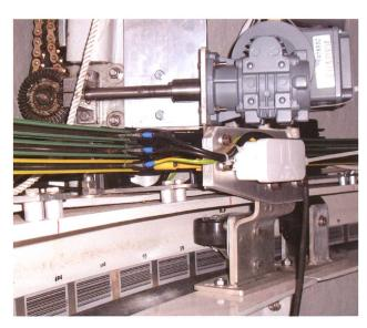
Figur 4: Rechts oben befindet sich der Motor des Torantriebs, darunter die Halterung der Stromabnehmer und die drei Schienen. Der Abstand vom Motor zur Oberkante der Halterung beträgt ca. 1 cm. Unterhalb der radialen Führungsrolle ist in der Vertikalen 2 cm Platz für die Strichcodes der Kuppelsynchronisation.
