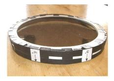
Der selbst hergestellte Polarisationsfilter, welcher während den Messungen vorne auf das Celestron Teleskop gesetzt wurde. Es sind noch die Winkelmarken zu erkennen, nach welchen der Filter jeweils ausgerichtet werden musste.
