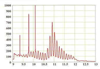
✓ Interferogramm der solaren Radiostrahlung vom Dienstag, 8. Januar 2008. Nebst starken Störungen zwischen 09:30UT und 10:15UT sieht man die interferometrische Überhöhung der gemessenen Strahlung zur Kulminationszeit. Die X-Achse zeigt die Messzeit in UT +/-Phasenfehler, die Y-Achse die Strahlungsintensität in normierten, nicht-physikalischen Einheiten.
