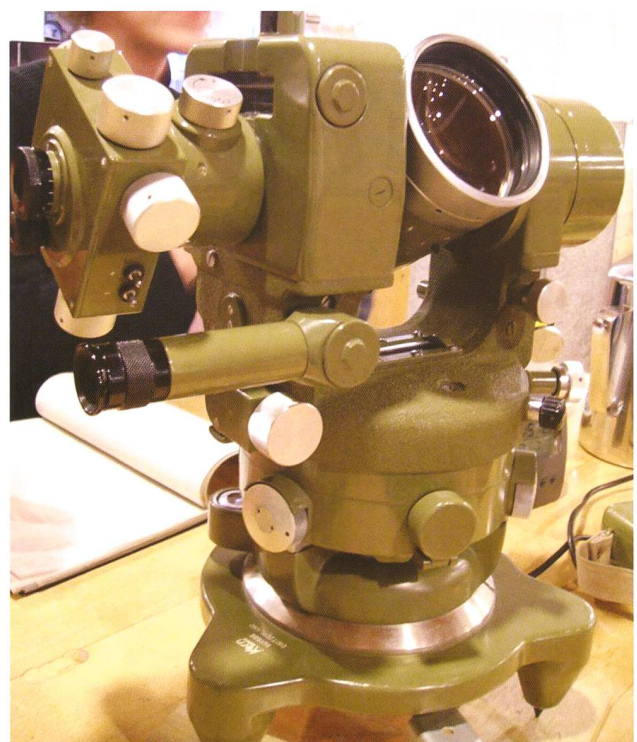
Der Theodolit Kern DKM 3-A. Mit diesem Gerät kann man mit hoher Genauigkeit den Zenitwinkel sowie das Azimut ablesen. Er kann auf einem Tisch- oder Feldstativ montiert werden.
