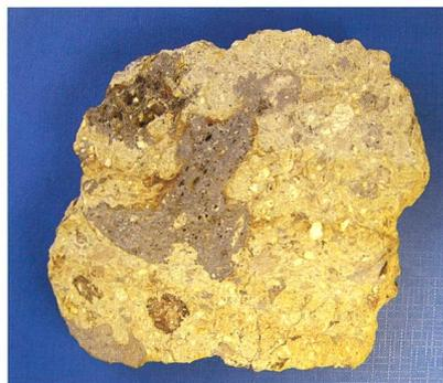
Eine aufgesägte und geschliffene Suevitprobe aus dem Steinbruch Aumühle zeigt das zermahlene Grundgestein mit dazwischenliegenden dunklen Schmelzteilen. Diese dürften Temperaturen von gegen 2'000 Grad erfahren haben. Sie sind mit vielen Entgasungskanälen durchsetzt.
