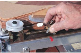
Figure 7 et 8: Le système de l'écrou basculant. (Photos: René Durussel)
