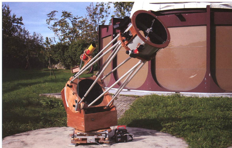
Figure 1: Le Dobson de la Société d'Astronomie du Haut-Léman Vevey est aussi un télescope à monture équatoriale. (Photo: R. Durussel)
