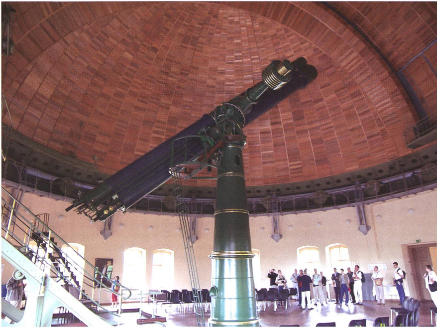
◀ Figur 2: Wunderschön restauriert und heute eine wissenschaftshistorische Kostbarkeit: Der visuell-fotografische Doppelrefraktor 50/80cm präsentiert sich auf seiner Repsold-Montierung seit gut einem Jahr wieder in alter Schönheit. (Bild: Markus Griesser)
