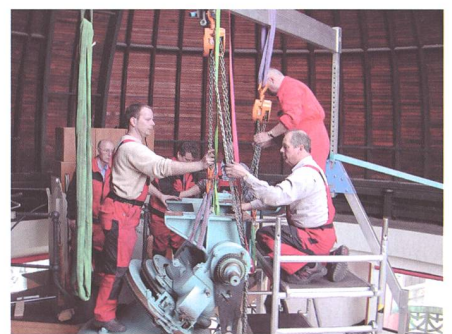
Fig. 12: Demontage der Deklinations- und Stundenachse; die vollständige Zerlegung in Einzelteile wurde erst im Zeiss-Werk Jena vorgenommen. Aufn.: AW
