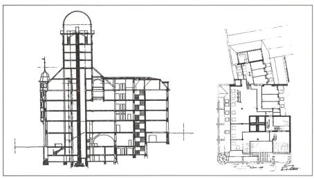
Fig. 3: Schnitt durch das Gebäude mit dem Kuppelraum und dem Dachgeschoss-Grundriss des Geschäftshauses "Urania" mit dem kreuzförmigen Instrumentenpfeiler. Die Fundamentplatte ruht auf 48 Eichenpfeilern. Fundamentplatte und Instrumentenpfeiler sind vom übrigen Gebäude getrennt, damit keine Erschütterungen auf das Instrument übertragen werden.
