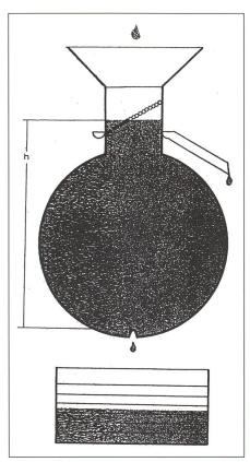
Abb- 2 Prinzip der kalibrierbaren Durchlauf-Wasseruhr.
