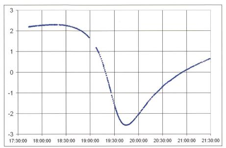
Fig. 4: Auswertung der Fourierspektren über die ganze beobachtete Zeit des 2. September. Die x-Achse beschreibt die Messzeit in UT (universal time), die y-Achse zeigt den Geschwindigkeitsanteil in Richtung Erde ausgedrückt in km/sec. Die Maximalgeschwindigkeit beträgt etwa 2.5km/sec.
