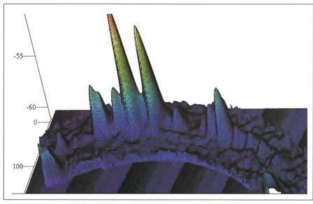
Abb. 4: Dreidimensionale Darstellung der geostationären Satelliten-Bahn in terrestrisch topozentrischen Koordinaten (Azimut, Elevation). Die Z-Achse zeigt die am Empfängerausgang gemessene Rauschleistung in dBm. Man kann verschiedene Satelliten mit unterschiedlicher Leistung erkennen. Es wurde hierbei nur die horizontale Polarisation berücksichtigt.
