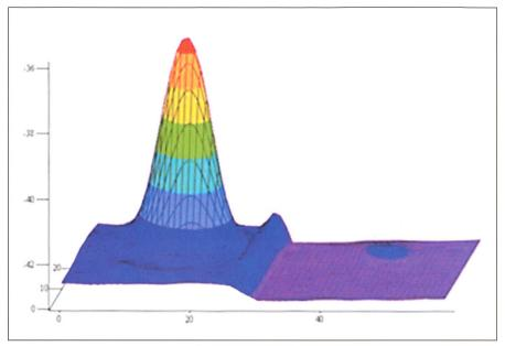
Abb. 3: Surfaceplott von Sonne (links) und Mond (rechts) im gleichen logarithmischen Massstab bei etwa 10.47GHz. Die Z-Achse ist in dBm aufgetragen (Dezi Bel bezogen auf 1mW am Empfängerausgang.). Die Amplitude des Mondes (kaum erkennbar) ist um Faktoren geringer als diejenige der Sonne bei identischem Öffnungswinkel der Antenne.
