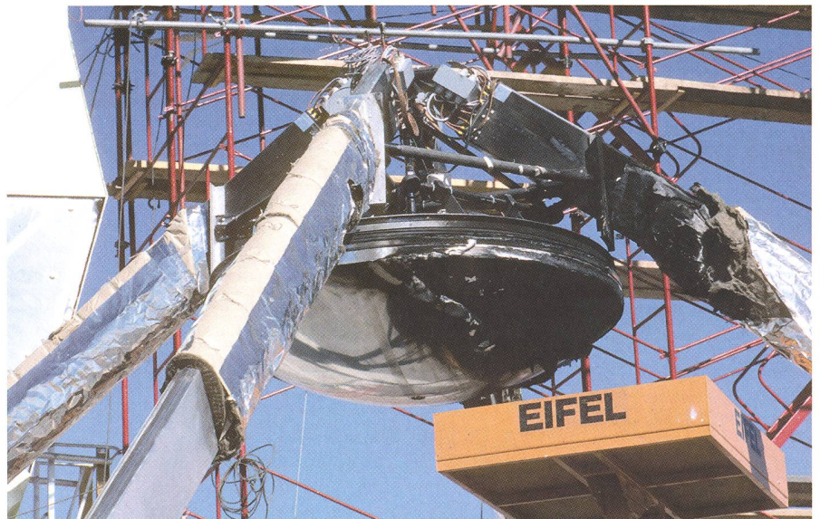
Fig. 16. Le miroir secondaire du SEST ayant subi sa «première lumière» – involontaire – avec le Soleil du solstice (décembre 1986).
