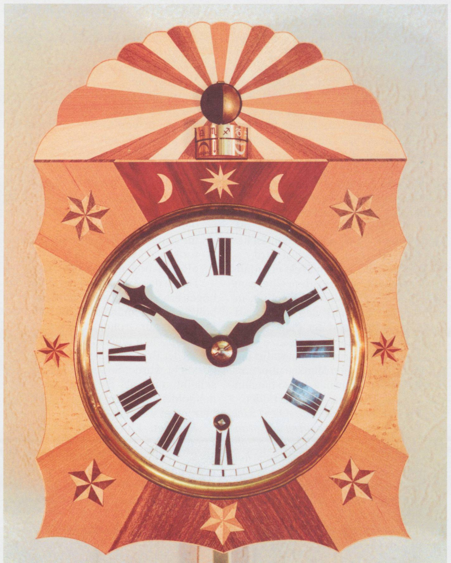
Fig. 1. Die Front mit dem römischen Zifferblatt und der astronomischen Monduhr. Auf der Monduhr können die Mondphasen, der Lauf des Mondes durch den Tierkreis sowie der «obsigende» bzw. der «nidsigende» Mond abgelesen werden. Zu sehen sind ferner die Intarsien, die Sonne, Mond und Sterne darstellen. Die obere Umrandung des Zifferblattes steht für das einem Beobachter abgeflacht erscheinende Himmelsgewölbe; der untere Teil (unter der Trennlinie) ist ein Sinnbild für den durch Berge, Hügel und Täler begrenzten natürlichen Horizont.
