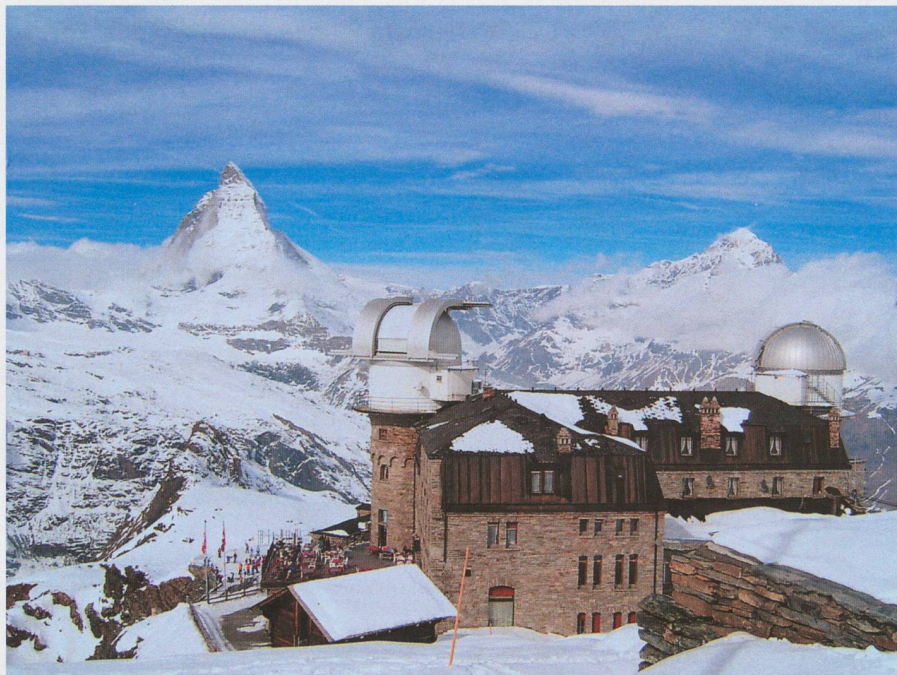
Fig. 3: Observatorium KOSMA (linke Kuppel) auf dem Gornergrat bei Zermatt. Hier wurden die ersten Messungen an verschiedenen Sternentstehungsgebieten und in der Erdatmosphäre durchgeführt. Nur in dieser Höhe ist es möglich mit Millimeter – und Submillimeterwellen astronomisch zu beobachten. Tiefer unten stört die Erdatmosphäre bzw. deren Wasserdampfgehalt die Messungen zu stark. Die weisse Plane vor dem Kuppelspalt schützt die empfindliche Mikrowellenelektronik vor direkter Sonneneinstrahlung. Direkte Wärmestrahlung der Sonne würde die supraleitenden Mischer-Halbleiter sofort zerstören.
