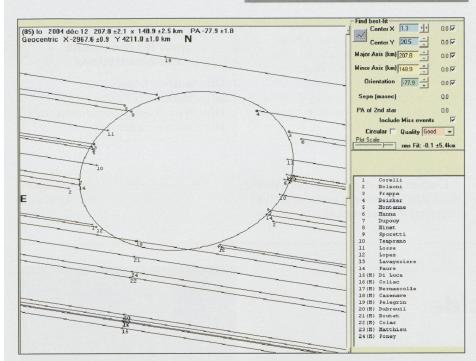
Fig. 2. La silhouette de l'astéroïde (85)lo capturée lors de l'occultation du 12 décembre 2004. Les «cordes» numérotées sont relatives aux observateurs. A partir de la longueur des interruptions des cordes (proportionnelle à la durée des occultations) on peut estimer les dimensions de l'astéroïde qui sont de environ 200x150km.
