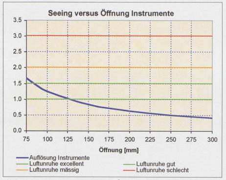
Abb. 8: Bestimmen der notwendigen minimalen Öffnung des Teleskops in Abhängigkeit vom
