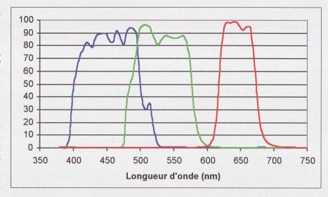
Figure 3. Transmission spectrale des filtres RGB.
