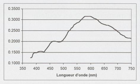
Figure 2. Rendement quantique du capteur KAF-0401E.
