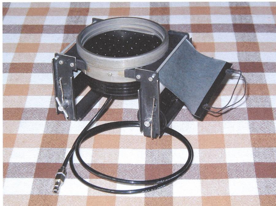
Fig.2: Filmkassette mit Halterung für Mittelformatfilm und Vakumschlauch zum Ansaugen des Filmes. Nicht sichtbar ist die lichtdichte Abdeckung, welche nach Einsetzen der Filmpule über diese gestülpt wird.
