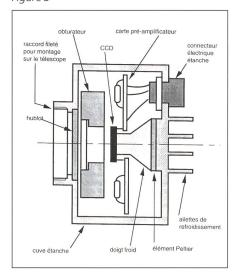
Le schéma ci-contre montre le fonctionnement d'une caméra CCD:
