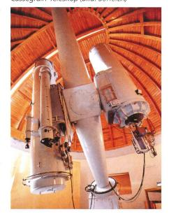
meinsamen Deklinationsachse befestigt, ihre Gewichte kompensieren sich gegenseitig und machen ein zusätzliches Gegengewicht unnötig (siehe Figur 2). Diese Art der Montierung ermöglicht es, zwei grössere Instrumente in einer einzigen Kuppel unterzubringen.
