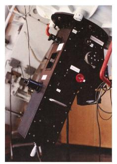
Figur 6: Gitterspektrograph im Cassegrainfokus des 60cm-Teleskops (Bild: Ch. Trefzger)
