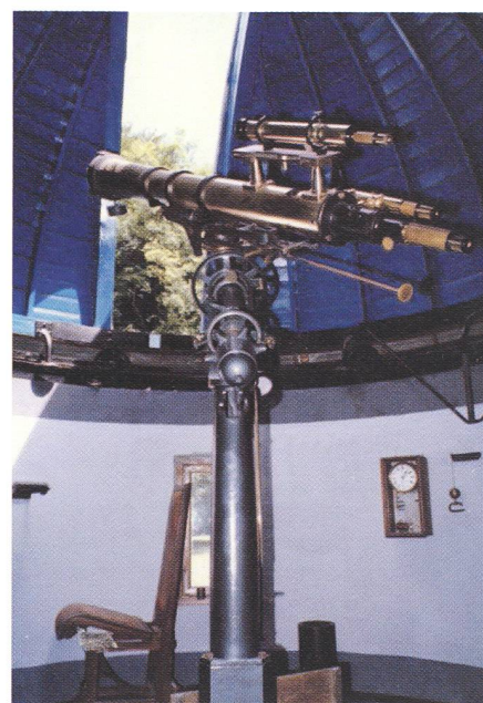
Fig. 9 – La lunette de 162mm de la coupole Sud, aujourd'hui au Musée de l'Instrumentation d'Optique de Biesheim. Elle est photographiée ici en station intermédiaire dans une coupole du jardin de l'observatoire. (© J. Marcout & Obs. Astron. Strasbourg)
