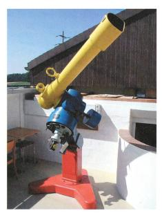
Fig. 2: **Zeiss Coudé-Refraktor** Zeiss Coudé-Refraktor mit 15cm Öffnung und ortsfestem Einblick. Einsatzbereich: hauptsächlich Planeten- und Sonnenbeobachtung. Standort auf der Beobachtungsplattform im Sektor Nordwest.
