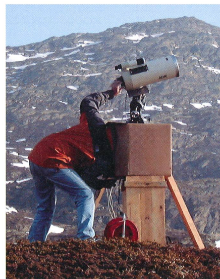
Fig. 2: Scharfstellen der von der WebCam an den Laptop übermittelten Bilder.
