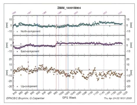
Fig. 2: Wöchentliche Positionsbestimmungen im Europäischen Bezugssystem.
