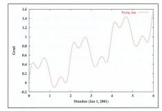
Fig. 20: Störungen des Perigäumsabstandes durch die Abplattung .
