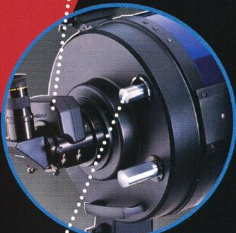
**Hauptspiegelfixierung:** Stellt den Hauptspiegel des Teleskops fest. In Verbindung mit dem „Zero-Image-Shift“ Mikrofokussierer beseitigt die Hauptspiegelfixierung jegliches Shifting beim Fokussieren während visueller, fotografischer oder CCD-Beobachtungen.
