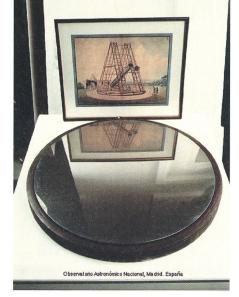
Fig. 3: Ce miroir original du télescope construit vers 1800 par William Herschel pour l'Observatoire de Madrid est en bronze, mesure 60cm et est placé dans un support en bois de 66cm environ. (© OAN)
