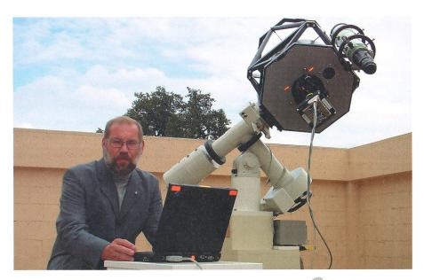
Fig. 1: Markus Griesser in «Beobachtungsposition» am 40cm-Teleskop mit der neuen, grossflächigen CCD-Kamera, einer Ap-8. Etwas strapaziös wird die Arbeit am portablen Computer bei minus 15 Grad Kälte oder auch in Nächten mit hohem Tauniederschlag.
